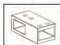
**Conexión en "T" para barra seguridad**
